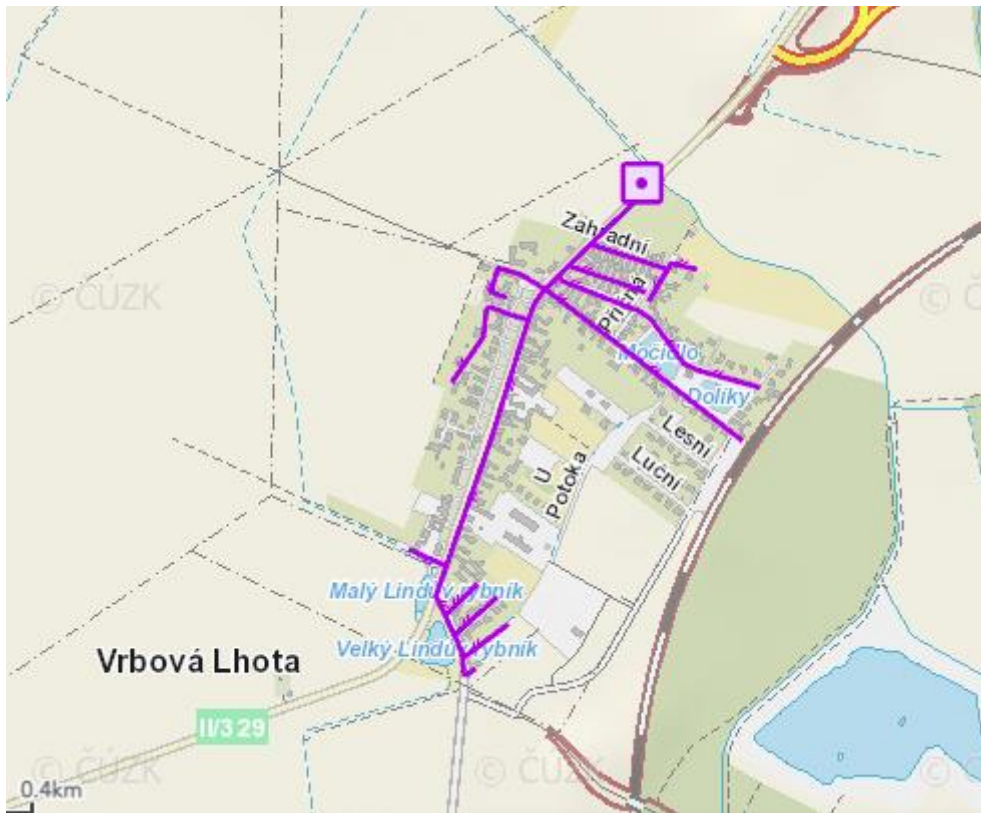
Obrázek 5 - Kanalizace v obci Vrbová Lhota
